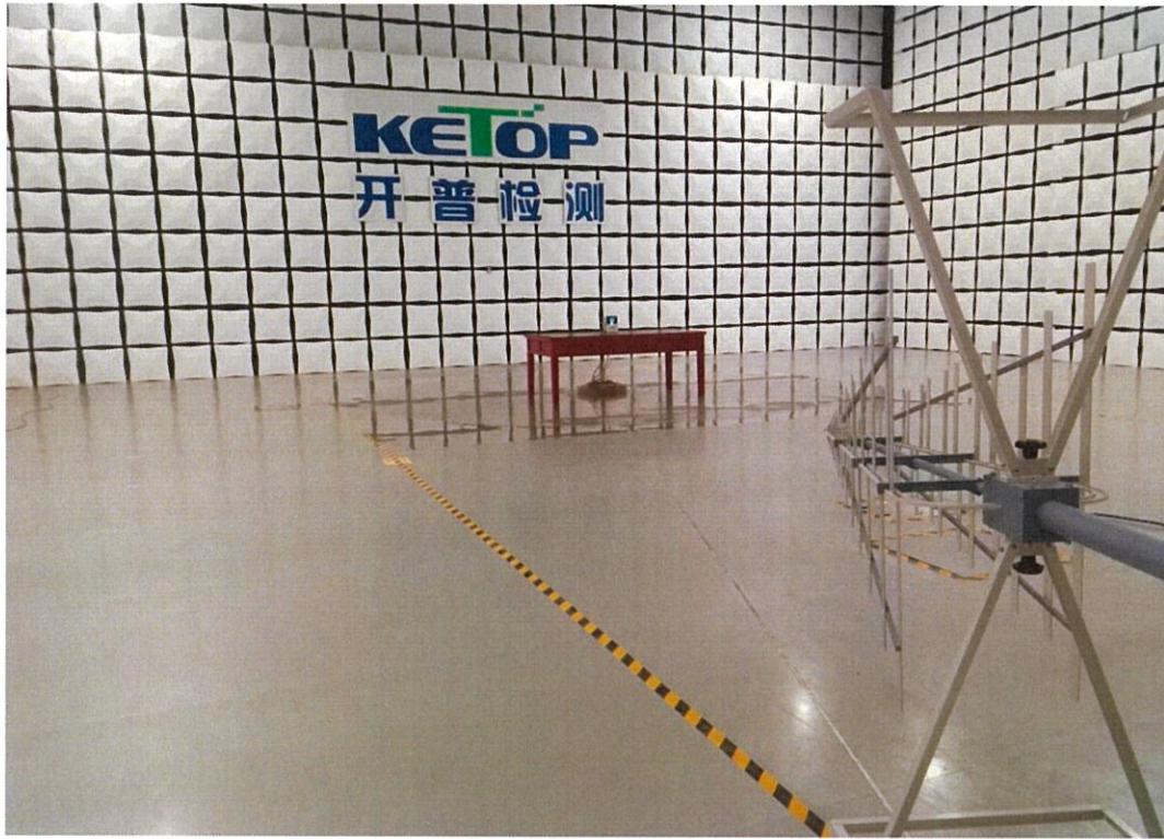
图 1: 辐射发射限值检验配置图
