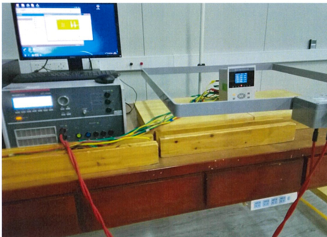
图 11: 阻尼振荡磁场抗扰度检验配置图
