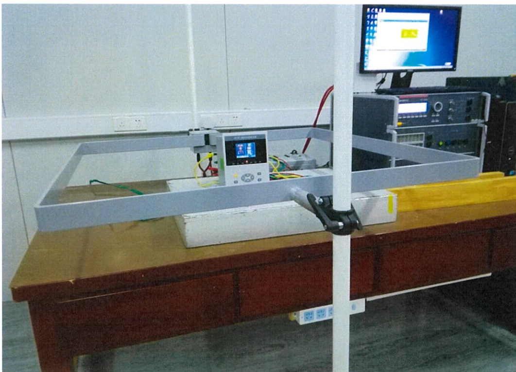
图 10: 脉冲磁场抗扰度检验配置图
