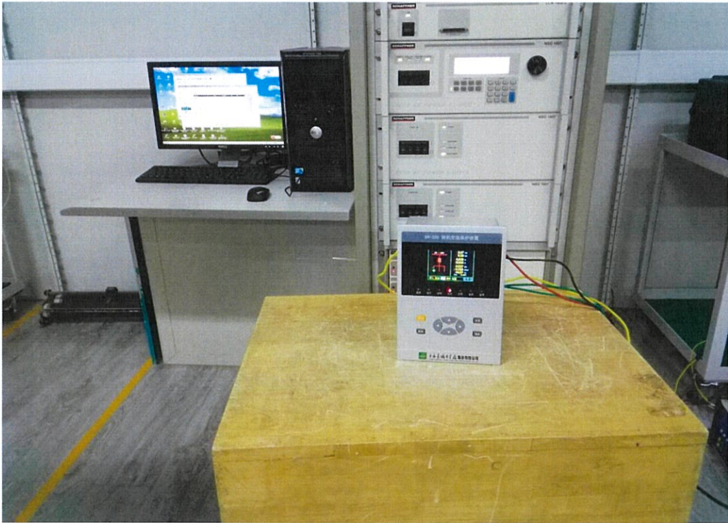
图 13: 交流和直流电压中断检验配置图
