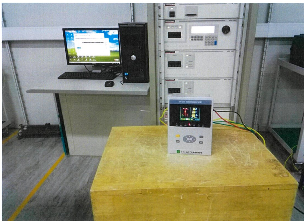
图 12: 交流和直流电压暂降检验配置图
